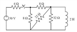
(A)  $2.5e^{-4t}$  (B)  $5e^{-4t}$  (C)  $2.5e^{-0.25t}$  (D)  $5e^{-0.25t}$  **Key: (A) Exp:** at  $t = 0^{-}$   $50V^{+}$   $8\Omega$  $I_{L}(O)$
